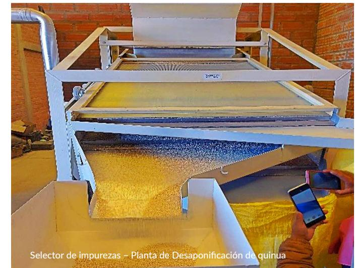
Selector de impurezas - Planta de Desaponificación de quinua
