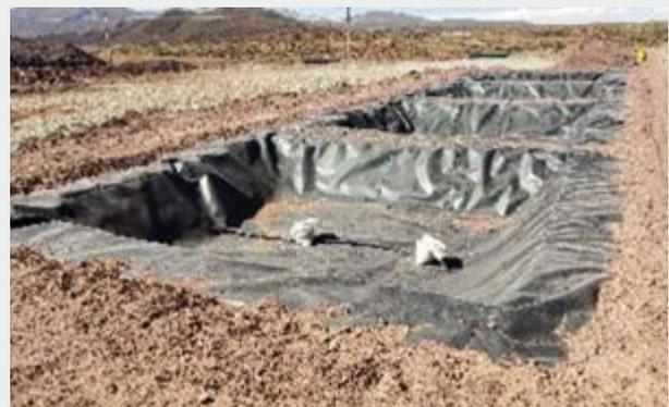
Celdas de pruebas hidráulicas.
